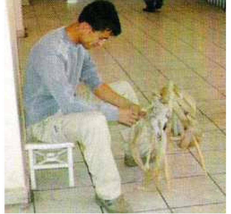
Skada işlenen tiftik ipinin ilmek ilmek tarak dişlerine bağlanması
